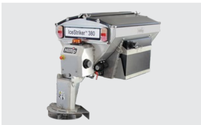
IceStriker™ 380 mit Vorbefeuchtungs-Salzlösungs-Kit, Düsen, Pumpe, Tank.
