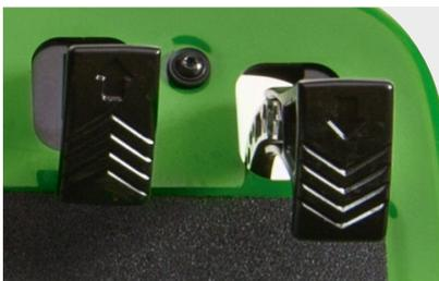
**eHydro™ System:** Das neue eHydro™-System verbessert mit seiner leichtgängigen 2-Pedal-Fußautomatik spürbar den Bedienkomfort. Zusammen mit Geschwindigkeitsfixierung und Wendegeschwindigkeitsmanagement schafft dieses System mit seinem guten Ansprechverhalten eine intelligente Maschine.
