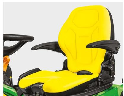
**Fahrsitz:** Sie haben die Wahl zwischen dem Komfortsitz mit verstellbarer Rückenlehne und optionalen Armlehnen oder dem neuen luftgefederten Sitz mit vollständig pneumatischer Federung.
