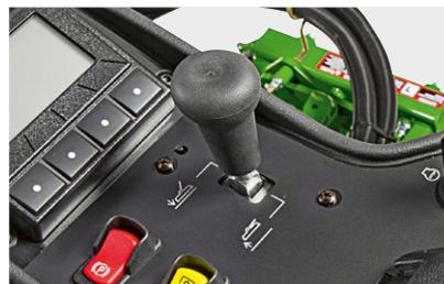
**Einfache Schnitthöheneinstellung:** Zur Schnitthöheneinstellung benötigen Sie keinerlei Werkzeug. Wählen Sie über den Hebel einfach die gewünschte Einstellung – und los geht's. Verglichen mit anderen Systemen stellen Sie damit Ihre Schnitthöhe deutlich schneller ein – das erhöht Ihre Produktivität und senkt Ihre Betriebskosten.
