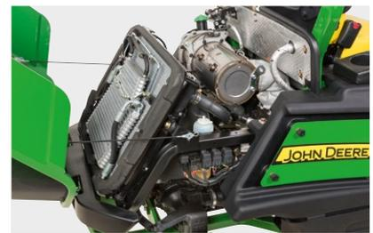
**Müheleose Wartung:** Die Wartung dieser Mäher könnte einfacher nicht sein: Alle täglichen Wartungspunkte sind leicht zu finden und gut zugänglich; das Mähwerk lässt sich zum schnellen Reinigen und Auswechseln der Messer einfach hochschwenken.
