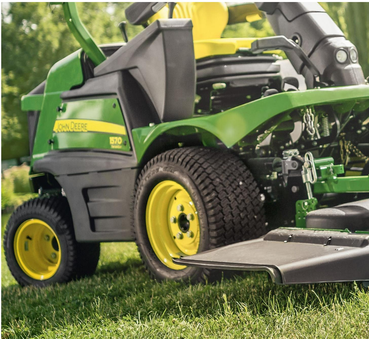
Mit Vierradantrieb und leistungsstarken 3-Zylinder-Dieselmotoren sind unsere Frontsichelmäher bestens gerüstet, um sich zügig den Weg durch unebenes Gelände zu bahnen. Dank des 60-Liter-Kraftstofftanks können Sie bis zu 10 Stunden ununterbrochen mähen, sodass der Mäher nicht eher ermüdet als Sie.
