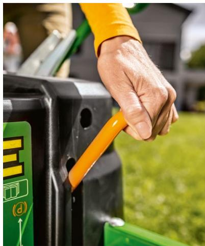
**Feststellbremse:** Die bequem erreichbare Feststellbremse hält die Maschine zuverlässig in der Parkstellung, selbst auf abschüssigem Gelände.
