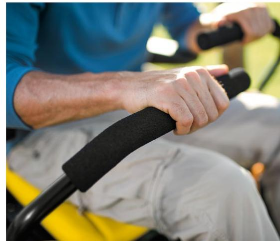
**Wenden auf der Stelle:** Zur Verbesserung des Fahrerkomforts und präziseren Steuerung können die Bedienhebel mit zwei verschiedenen Höhenpositionen und achtzehn verschiedenen Vor-Zurück-Einstellungen angepasst werden.
