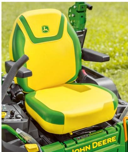
**ComfortGlide™:** Bei plötzlichen Starts und Stopps oder in unebenem Gelände federn die Sitzpolster Stöße ab, indem sie bis zu 5,1 cm nach vorne bzw. hinten gleiten.
