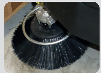
Seitenbesen mit Wasser-Sprüheinrichtung.
