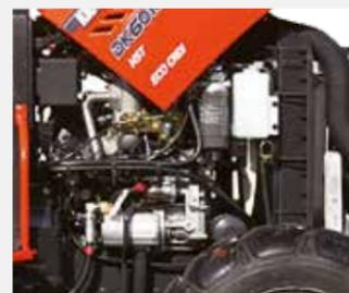
**COMMON RAIL DIESEL TECHNOLOGIE**
